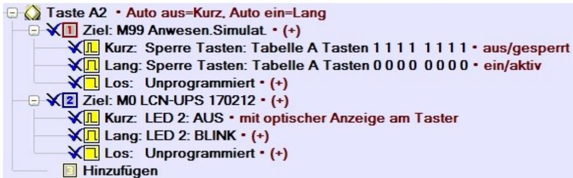
Ist der Anwender zu Hause, möchte er die Automatik natürlich 'aus' haben. Damit das auch nach einem Stromausfall gegeben ist, nutzen wir die LCN-Funktion 'Netzausfallerkennung' (Eigenschaften, Betriebsmeldungen). Sie schaltet automatisch nach Spannungswiederkehr die 'Automatik aus' (sperrt die Tasten)
