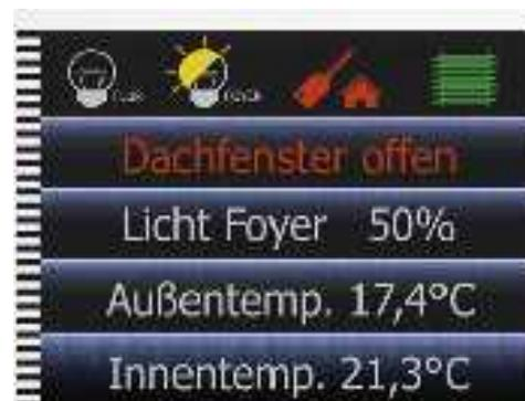
Der Anschluss erfolgt am I-Port eines intelligenten Moduls. Die Tasten wirken auf die D-Tabelle, die LEDs des LCN-GT6D sind unabhängig von den bisherigen LEDs programmierbar. Daher ist ein gleichzeitiger Betrieb mit anderen Tastenumsetzern möglich.
