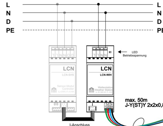
Wetterstation mit Auswerteeinheit für die Hutschiene
