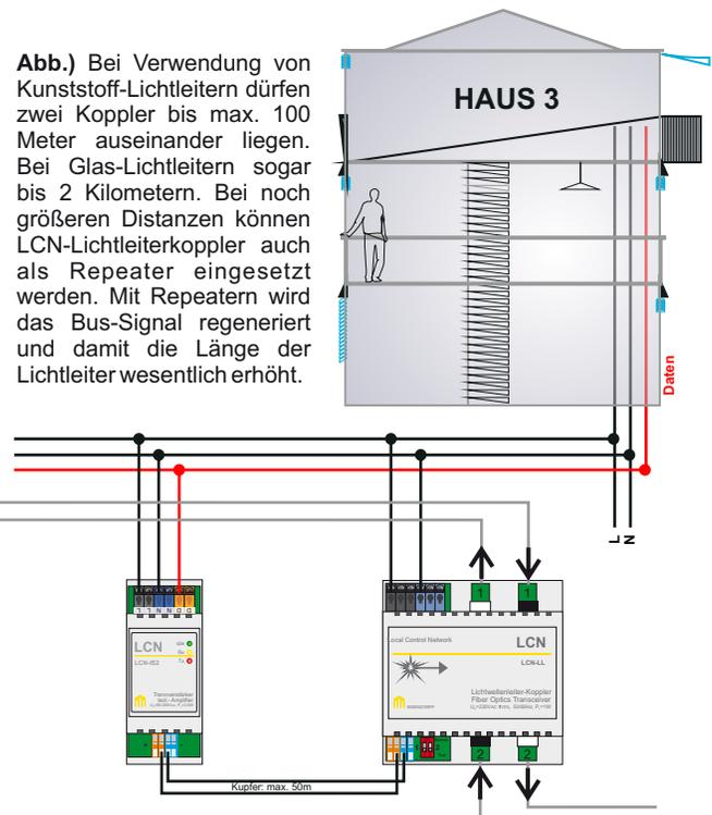
**Abb.)** Bei Verwendung von Kunststoff-Lichtleitern dürfen zwei Koppler bis max. 100 Meter auseinander liegen. Bei Glas-Lichtleitern sogar bis 2 Kilometern. Bei noch größeren Distanzen können LCN-Lichtleiterkoppler auch als Repeater eingesetzt werden. Mit Repeatern wird das Bus-Signal regeneriert und damit die Länge der Lichtleiter wesentlich erhöht.
