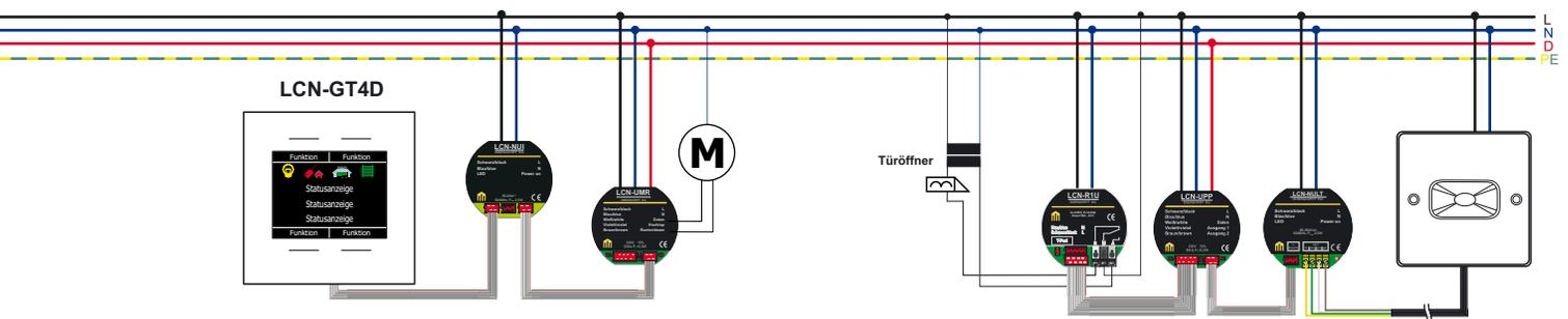
Zur Steuerung eines Rollladenmotors wird per LCN-UMR der Rollladenmotor direkt angesteuert. Zur Bedienung und für eine visuelle Rückmeldung über den Zustand, wird der Display-Taster LCN-GT4D integriert.
