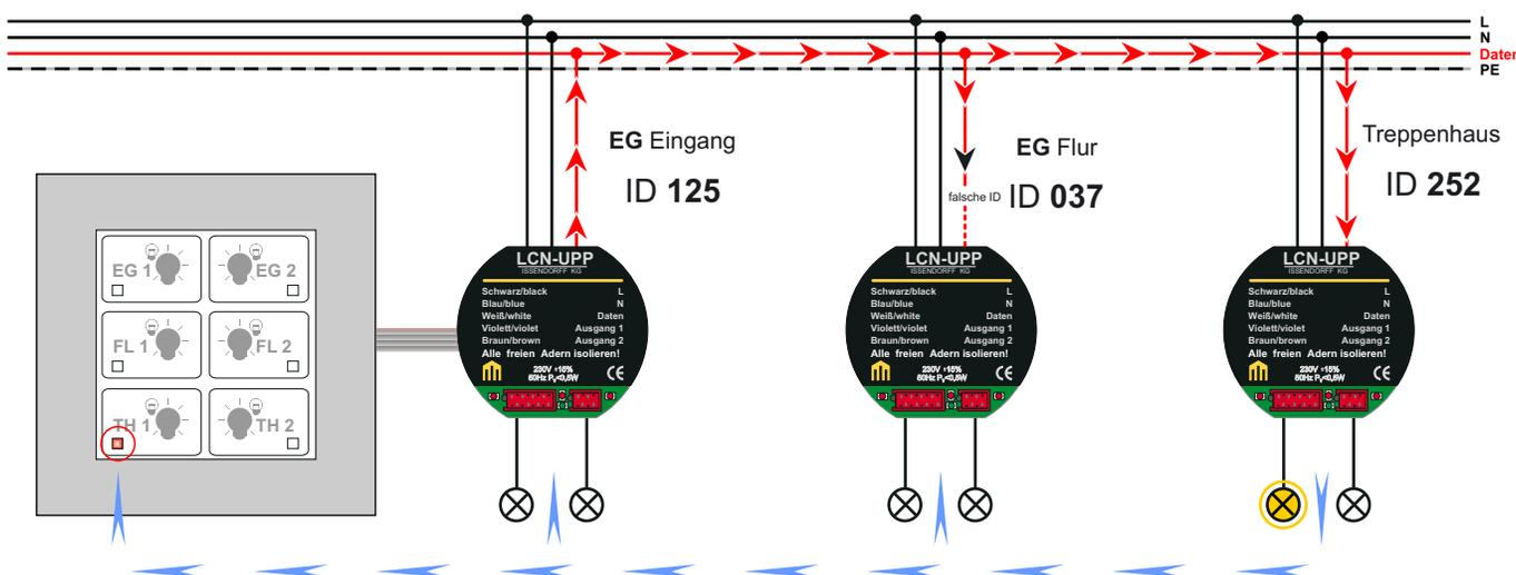
Die Statusmeldung von Modul 254 wird über die Datenader an alle Module im Bus gesendet und optisch durch die LED am Glastaster durch AN, AUS, BLINKEN oder FLACKERN dargestellt.
