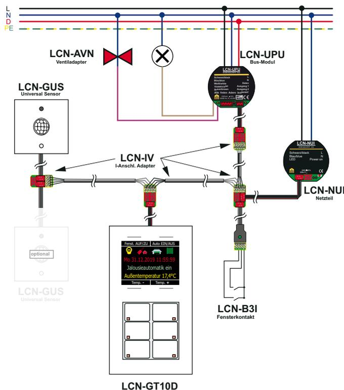
Abb.) Beispiel für mehrere Sensoren am gleichen Modul:
