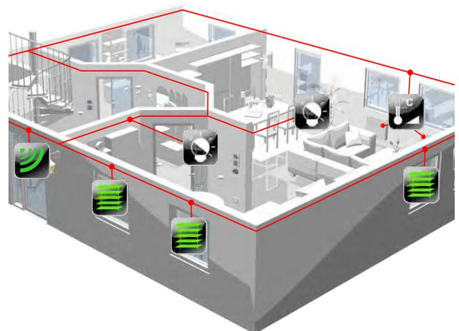
Zur Beschattung eines Raumes/Gebäudes sollen mehrere elektrische Rollläden automatisiert werden. Mit dem Motor-Relaisblock LCN-R4M2H können 4 x 2 Motorenpaare direkt angesprochen und gesteuert werden. Auf diese Weise lassen sich einzelne Zonen oder ein gesamtes Objekt mit nur einem Knopfdruck verschatten. Um einen zentralen, visuellen Statusreport zum aktuellen Zustand zu bekommen, wird der Display-Taster LCN-GT4D integriert.
