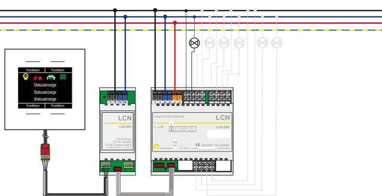
Die Temperatur innerhalb eines Raumes soll manuell vorgewählt und automatisch gehalten werden. Dazu werden die bestehenden Istwerte permanent mit den vorgegebenen Sollwerte verglichen. Dies geschieht über den in das LCN-GT4D integrierten Temperatursensor. So können Abweichungen jederzeit über die sechs einzeln ansteuerbaren Relais des LCN-SR6 an den entsprechenden Ventilen reguliert werden.
