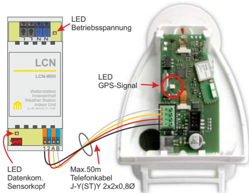
Bitte darauf achten, dass der Temperatursensor (an der Unterseite des Gehäuses unter weißer Vergussmasse) nicht beschädigt wird. Die Kabelverbindung zwischen Platine und Regensensor darf beim Anschluss nicht abgerissen oder geknickt werden.
