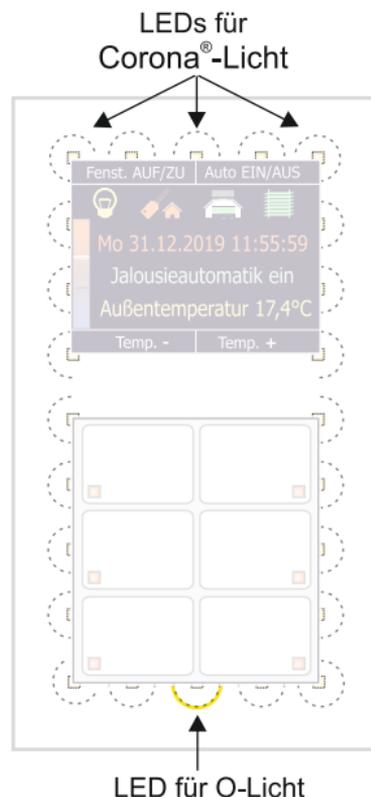
Auf dem 2,8" **TFT-Farbdisplay** können bis zu sechs Symbole, 3 Textzeilen mit jeweils bis zu 63 Zeichen und 4 Felder für die Tastenbeschriftung angezeigt werden. Bei Verzicht auf die Tastenbeschriftung sind sogar 4 Textzeilen möglich.
