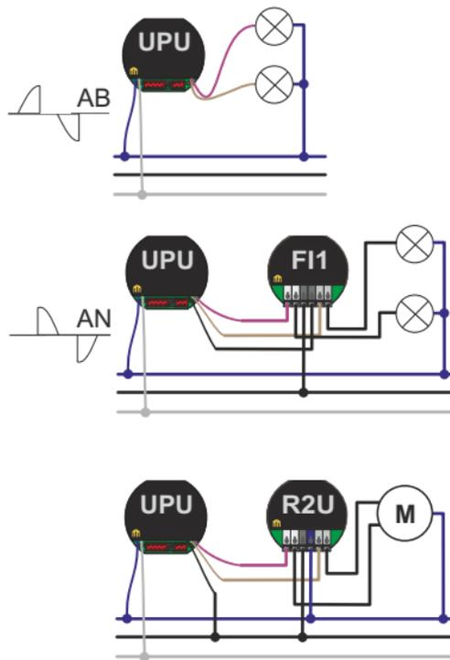
Der LCN-UPU überwacht die **Betriebstemperatur**. Steigt diese unzulässig hoch an, werden beide Ausgänge abgeschaltet und es wird eine Statusmeldung im Busmonitor der LCN-PRO abgezeigt: "Modul meldet Überlast/Übertemperatur".
