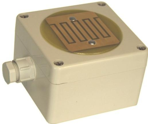
Zwei Metallflächen sind kammförmig angeordnet. In trockener Umgebung ist die Luft dazwischen ein Isolator – der kleine, ungefährliche Fühlerstrom kann nicht fließen. In feuchter Umgebung bilden die Wassertropfen eine leitfähige Brücke zwischen den Flächen, der Sensor löst aus, das eingebaute Relais zieht an.
