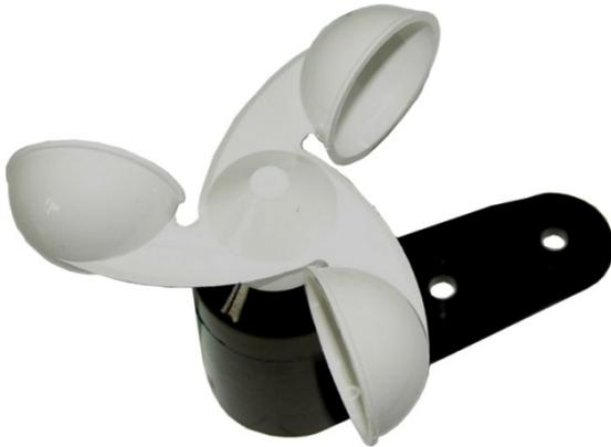
Der Wind lässt das Windrad (Schaufelrad) drehen. Im Gerät befinden sich auf dem Rotor Magneten. Daneben, fest montiert, ein Reedkontakt. Durch die Drehbewegung wirken die Magnete auf den Kontakt. Je nach Rotorstellung wird der Kontakt betätigt und geöffnet. So entstehen, durch die Drehbewegung des Windrades, Impulse. Je mehr Wind, desto mehr Impulse. Das fest angeschlossene Kabel ist ca. einen Meter lang und hat zwei Adern, daran ist der Reedkontakt angeschlossen.
