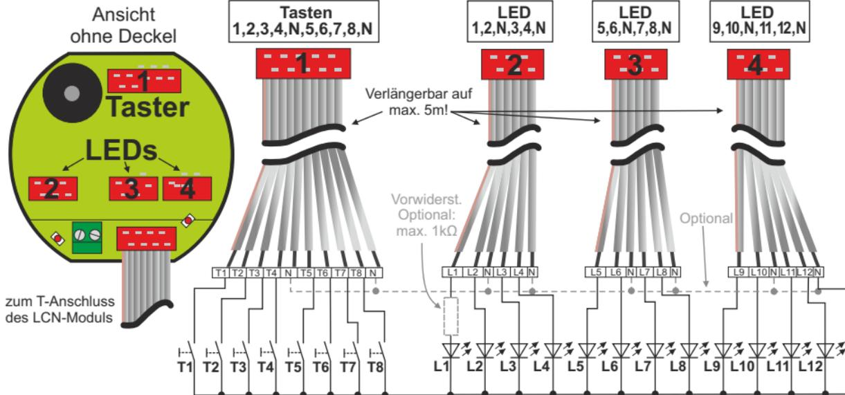
Die Anschlussleitungen führen N-Potential, diese sind im Modul gebrückt! Mindestens eine Verbindung muss angeschlossen werden!
