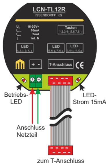
ist möglich LEDs direkt, ohne Vorwiderstand zu betreiben. Die Ansteuerung erfolgt entweder per Kommando (AN, AUS, BLINKEN, FLACKERN) oder über die Rück- bzw. Statusmeldungen. Über das Kommando „LED-Helligkeit“ kann der Betriebsstrom und somit die Helligkeit zwischen 1,8 mA und 15 mA umgeschaltet werden.
