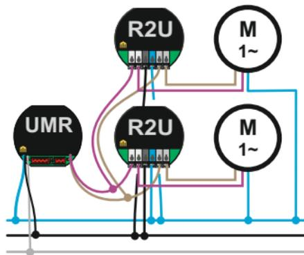
Einige Motortypen dürfen **nicht parallel** betrieben werden, das gilt auch **beim Betrieb über LCN-UMR!** Sie müssen die Motoren über Hilfsrelais trennen, z.B. mit LCN-R2U!
